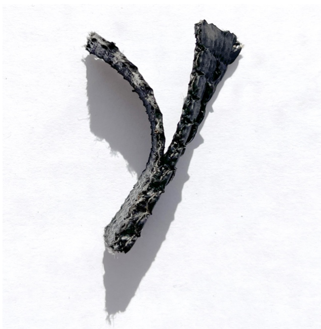
Рисунок 2 – Отслоение борта от основного полотна после обработки материала толуолом
